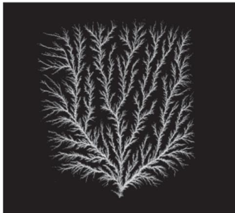
Um campo elétrico extremamente forte produziu ruptura dielétrica neste bloco de plexiglas. O escoamento resultante das cargas gravou esta configuração no bloco.
