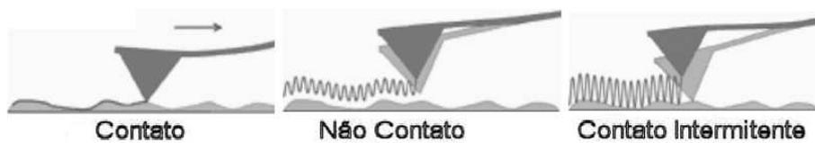
**Figura 1.4:** Figura ilustrativa dos modos de operação do aparato da AFM.[2]
