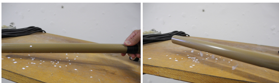
Fig. 1.2.1(a) e (b) Bastão de PVC atritado com pano de algodão atraindo pedacinhos de papel. (a) Um pedaço foi atraído e grudou no bastão; outro, por baixo do bastão, está erguido pela força de atração. (b) Com sorte no momento da tirada da foto alguns pedaços de papel estão em movimento e aparecem borradas na imagem.
