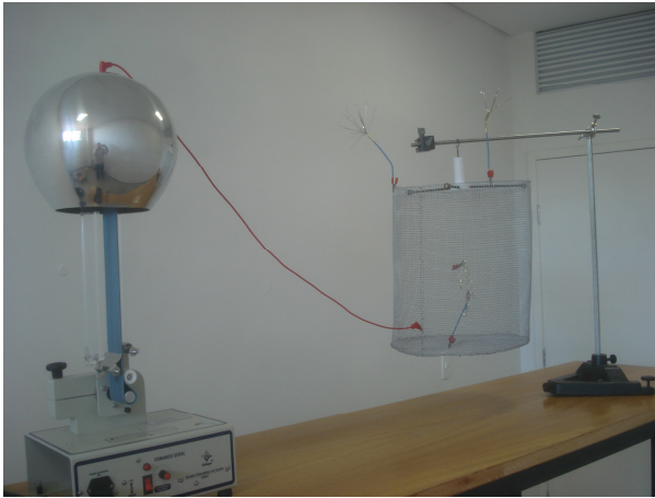
Fig. 2.4.1 Gaiola de Faraday ligada num gerador eletrostático do tipo Van de Graaff.
