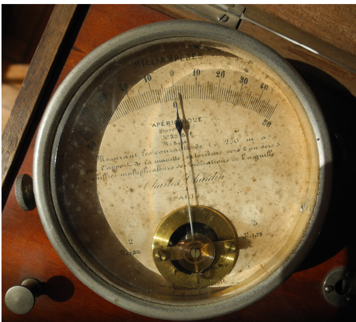
Fig. 5.1.14 Parte central de um galvanômetro. O fio de cobre enrolado na moldura retangular é tão fino e as espiras são tão densas que os fios não aparecem individualmente na fotografia. Dos quatro lados da bobina apenas um fica visível na imagem e este não recebe a ação do ímã. Os lados expostos ao ímã são aqueles que descem na fenda entre os polos do ímã (semiluas) e um cilindro maciço de ferro cujo eixo de simetria coincide com o eixo de rotação da bobina. Este cilindro ajuda a criar um campo magnético cujo módulo tem o mesmo valor para todas as orientações da bobina. A bobina retangular pode ser considerada como um balanço duplo. A fotografia foi tirada de uma peça do acervo histórico da Universidade Federal de Juiz de Fora.
