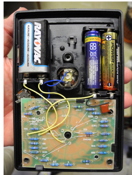
Fig. 5.6.13 O multímetro analógico da figura 5.6.12 aberto.
