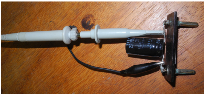
Fig. 5.8.4 Capacitor eletrolítico montado numa placa de fenolite com pinos banana e com uma ponta de prova de osciloscópio grampeada nas pernas do capacitor.
