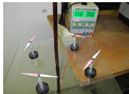
As bússolas indicam que as linhas de força do campo \vec{B} parecem circular em volta do fio. Isto é muito
