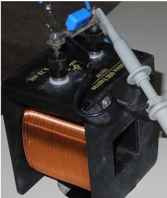
Fig. 9.2.2 Circuito RLC. O elemento R é apenas a resistência do fio da bobina. O capacitor é o bloquinho azul montado numa fita de placa de circuito com dois pinos banana. Esta fita de placa foi espetada nos borns dos terminais da bobina. Uma ponta de prova de um osciloscópio está grampeada nas pernas do capacitor.
